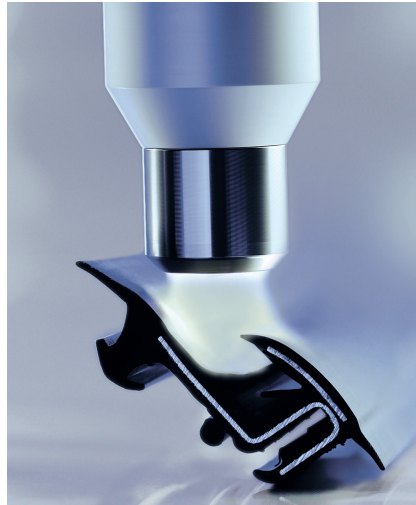
Bild 3. EPDM: Die Oberflächenbehandlung aktiviert das unpolare Material für Tür- und Fensterdichtungen von Fahrzeugen und bereitet die nachfolgende Beschichtung in einem schnelleren und vor allem saubereren Prozess vor © Plasmatreteat
