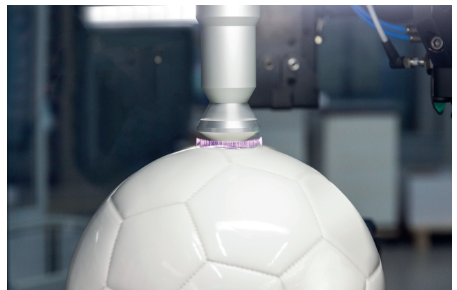
Bild 4. Polyurethan: Eine Behandlung mit Openair-Plasma ermöglicht dauerhaft beständige Druckbilder auf Objekten, die hohem mechanischen Stress ausgesetzt sind © Plasmatreteat
